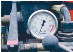
**Réglez la pression** pour obtenir un volume de gouttelettes adapté au produit utilisé et au résultat escompté.
