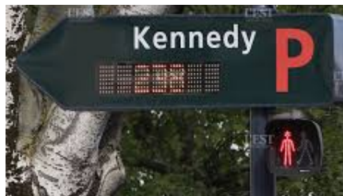
Exemple de jalonnement dynamique
