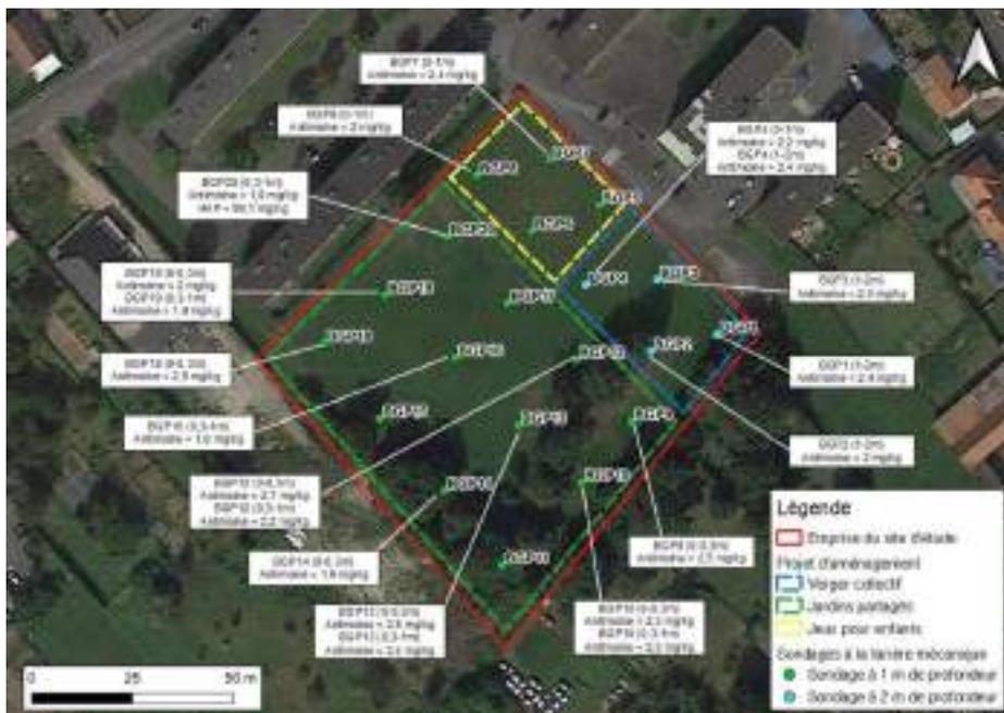
Figure 77 : Résultats de la mission A200 et cartographie des anomalies dans les sols – Source : Annexe supplémentaire 01
