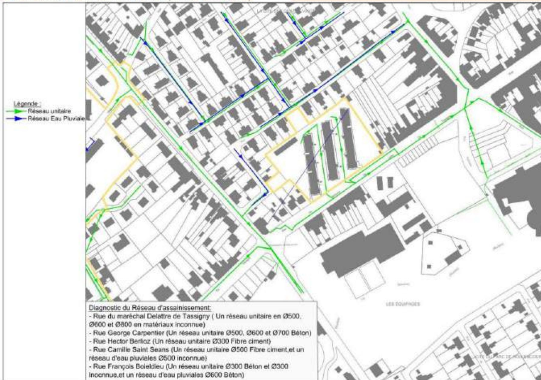
Figure 75 : Plans des réseaux d'assainissement existants des deux secteurs d'étude – Source : Permis d'Aménager
