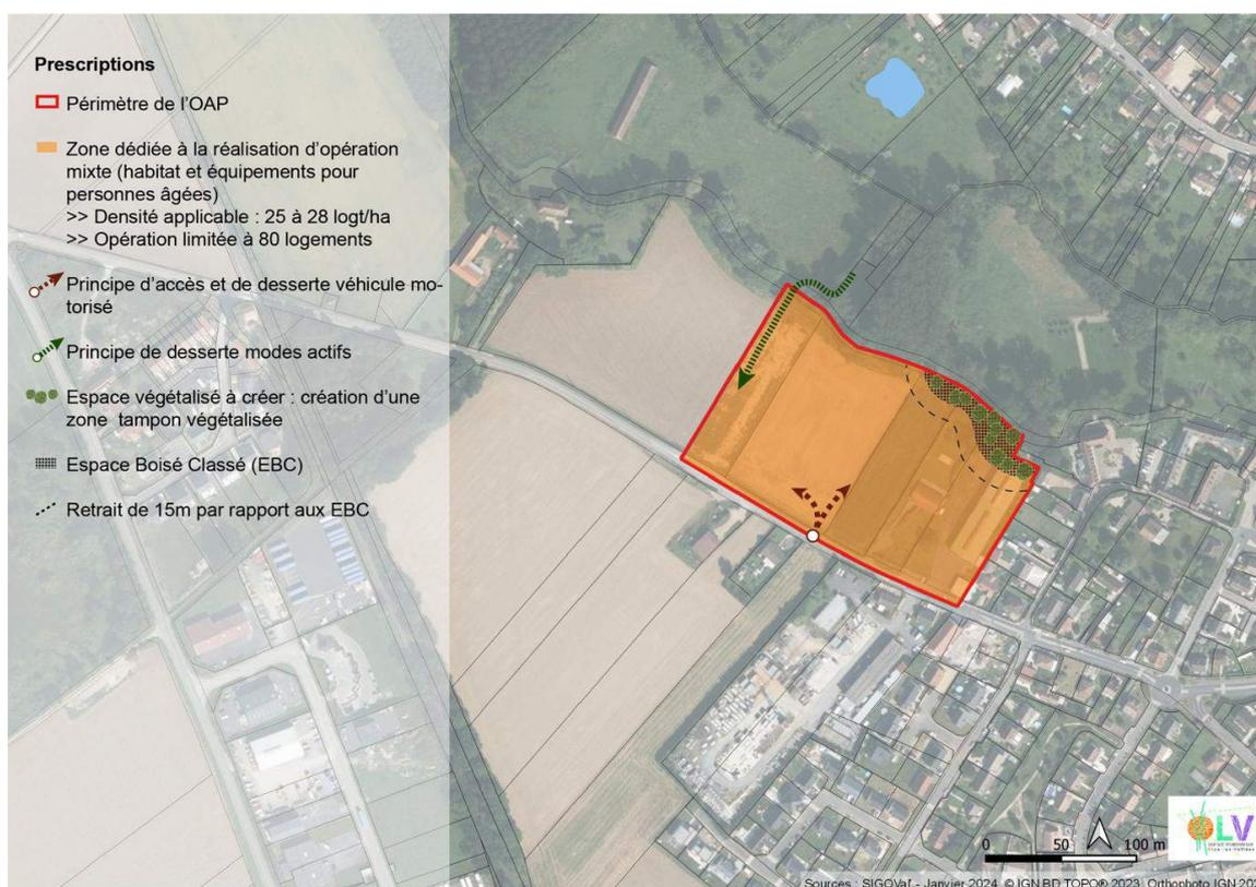
Figure 3: OAP du PLUiH révisé-Source : ARC
