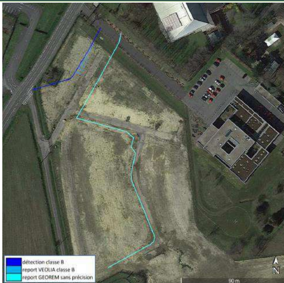
Figure 6: Réseau d'eau potable
