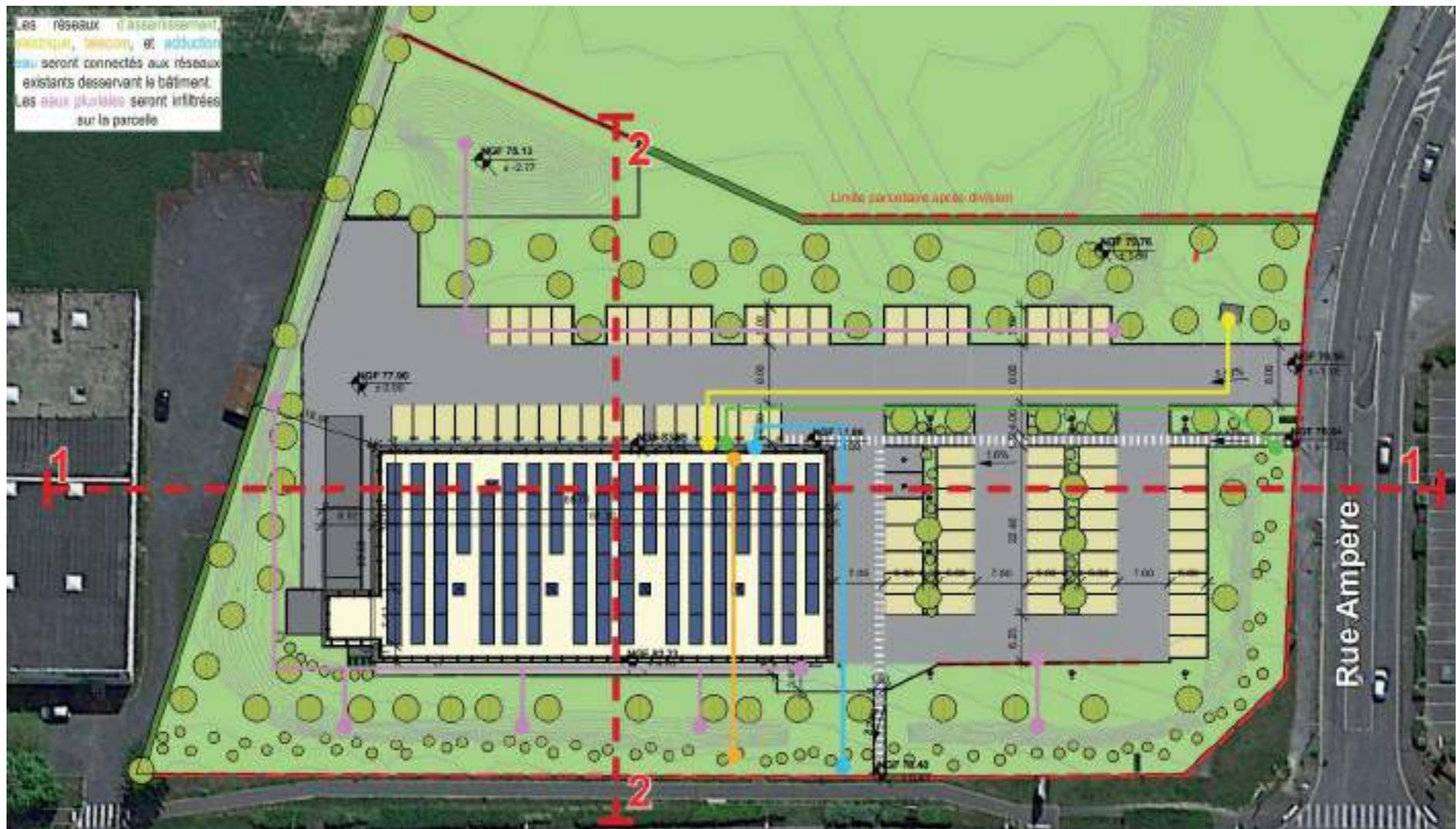
Figure 31 : Plan du réseau d'assainissement, électrique, télécom, adduction eau et eau pluviales au niveau du projet - Source : Permis de construire
