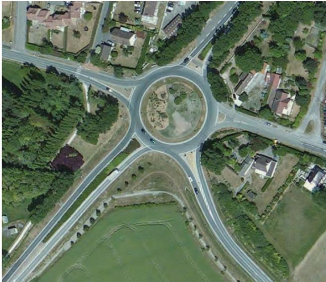
Pour tester le fonctionnement du carrefour RD601 x RD11, les flux ont été simulés sous Girabase, en tenant compte de la géométrie et les trafics tournants de ce carrefour.
