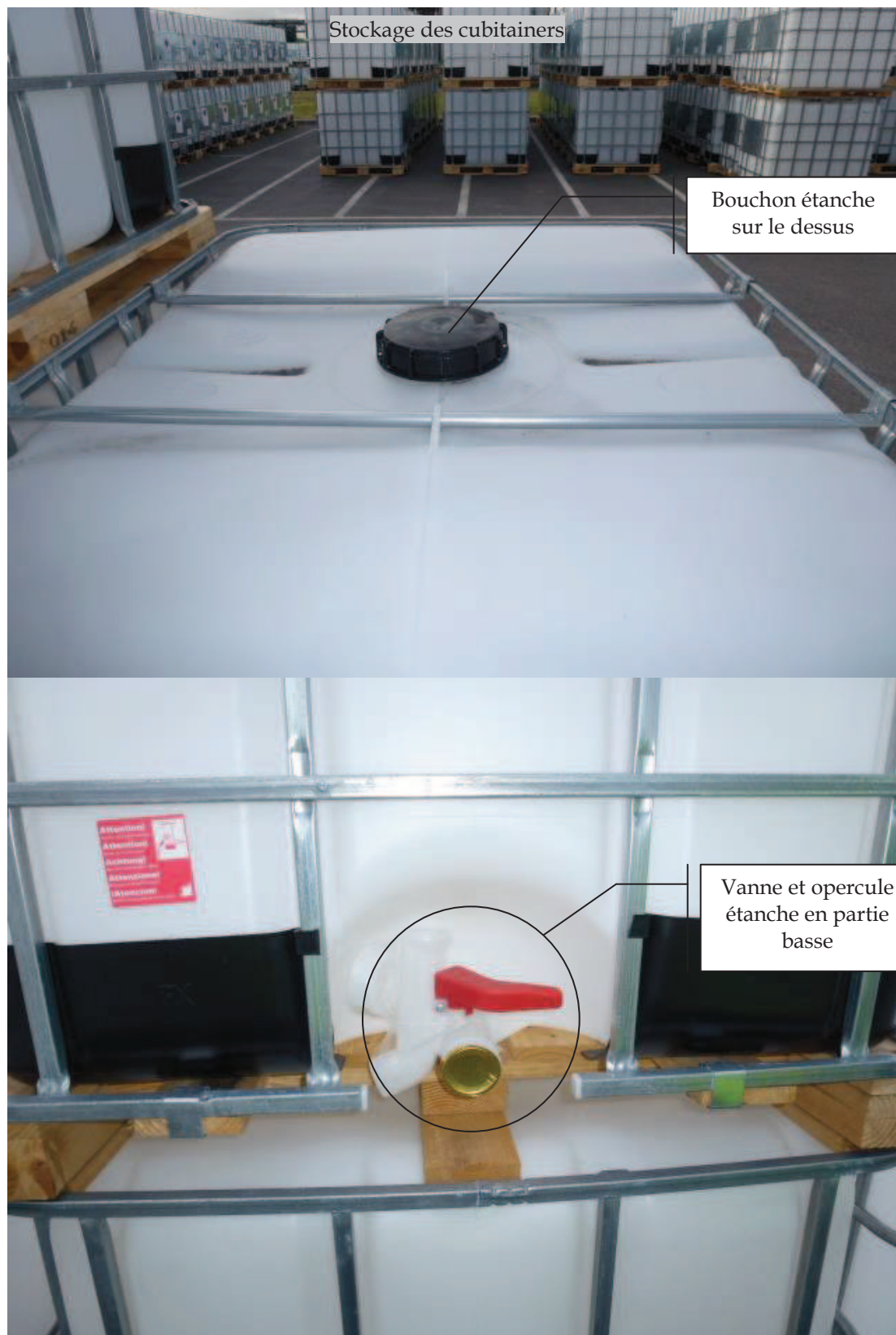
Figure 4 : Vanne et opercule en partie basse et bouchon étanche en partie haute d'un cubitainer
