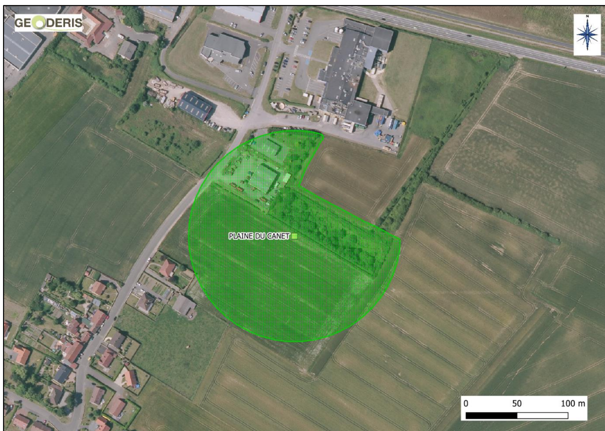
Figure 3 – Nouveau tracé de l'aléa « effondrement localisé » de niveau faible associé au puits Plaine du Canet
