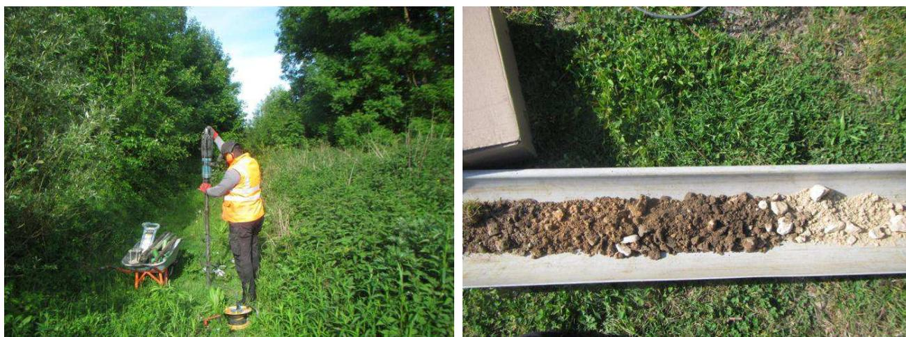
Figure 16 : Technique de forage au carottier portatif à gouges
