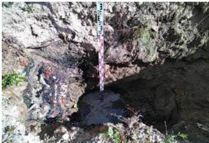
Essai de perméabilité "en grand" entre 2 et 2,15 m
