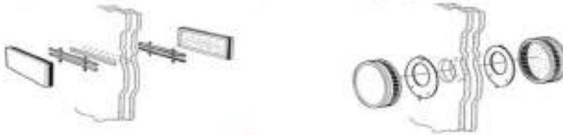
Figure 15 : Schémas de principe de la mise en œuvre d'un transfert d'air à travers une cloison
