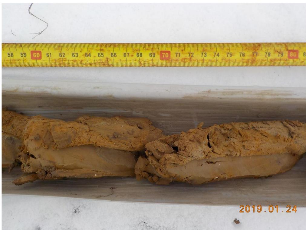
Vue sur les traces d'oxydation (traces rouilles) observées sur le sondage AN1
