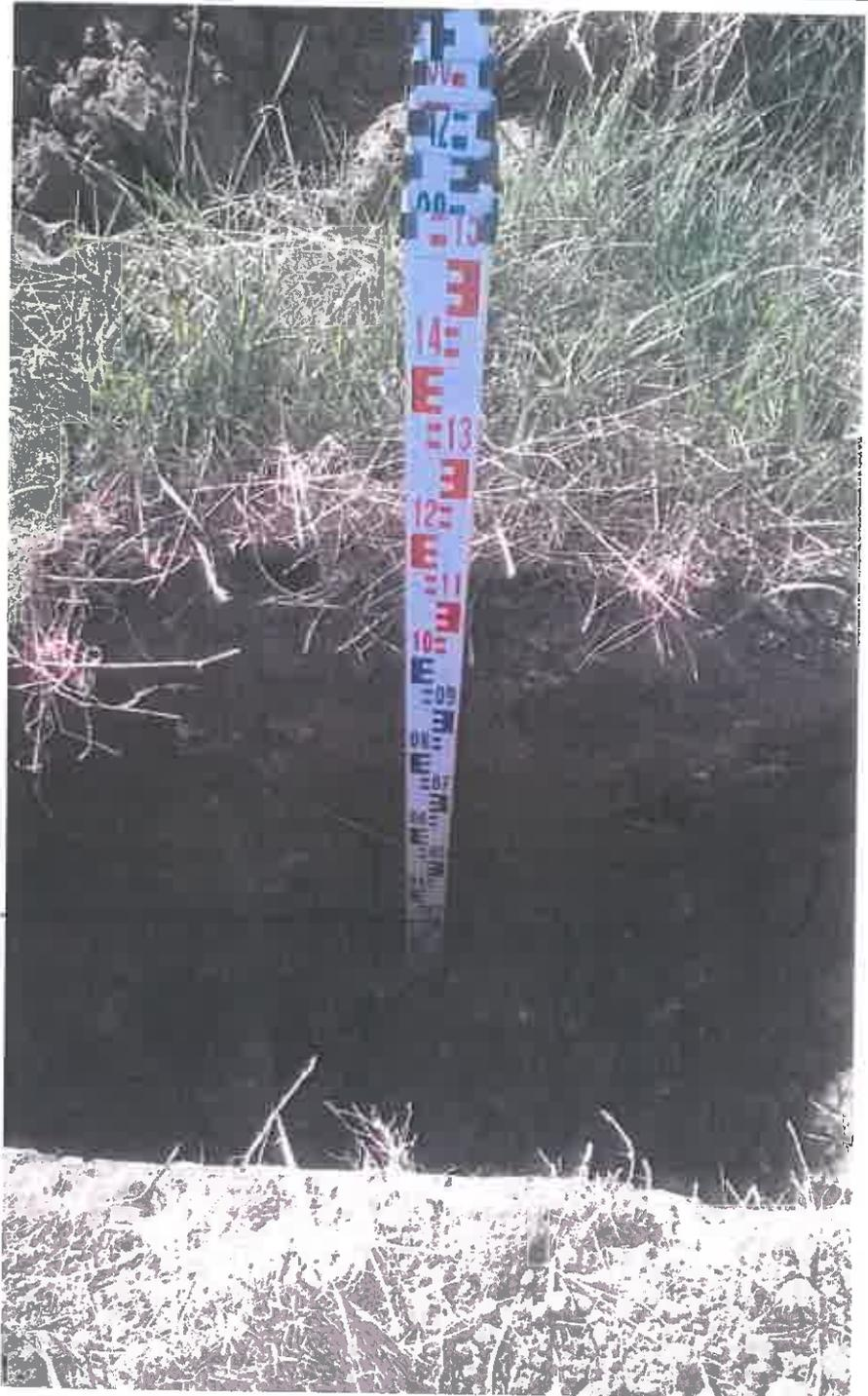
Essai de perméabilité "en grand" entre 0,91 m et 1,2 m de profondeur
