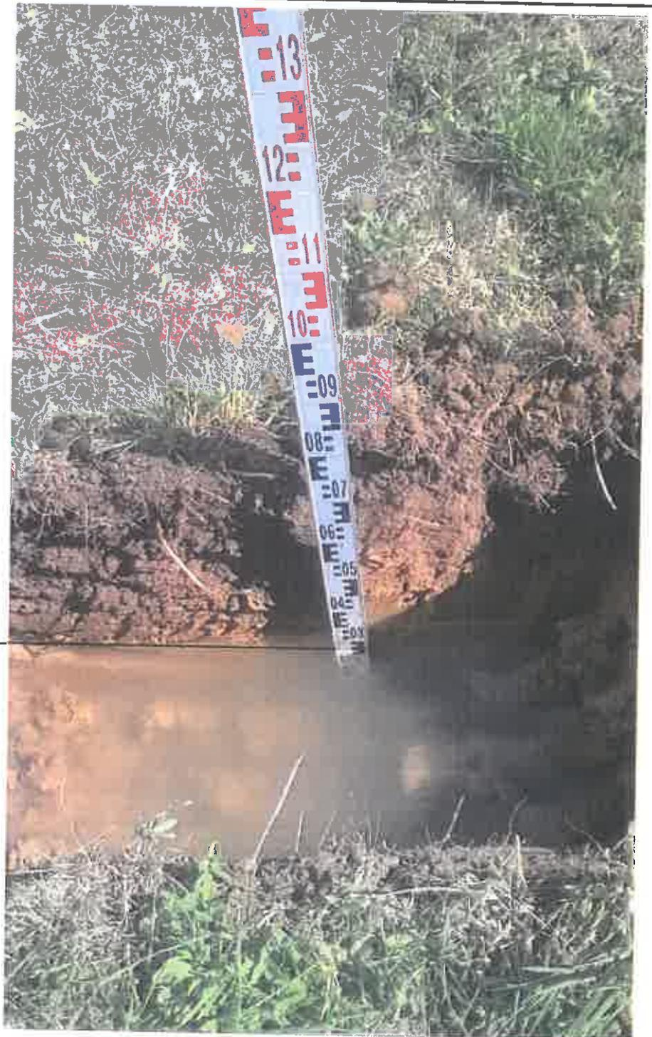
Essai de perméabilité "en grand" entre 0,53 m et 0,8 m de profondeur
