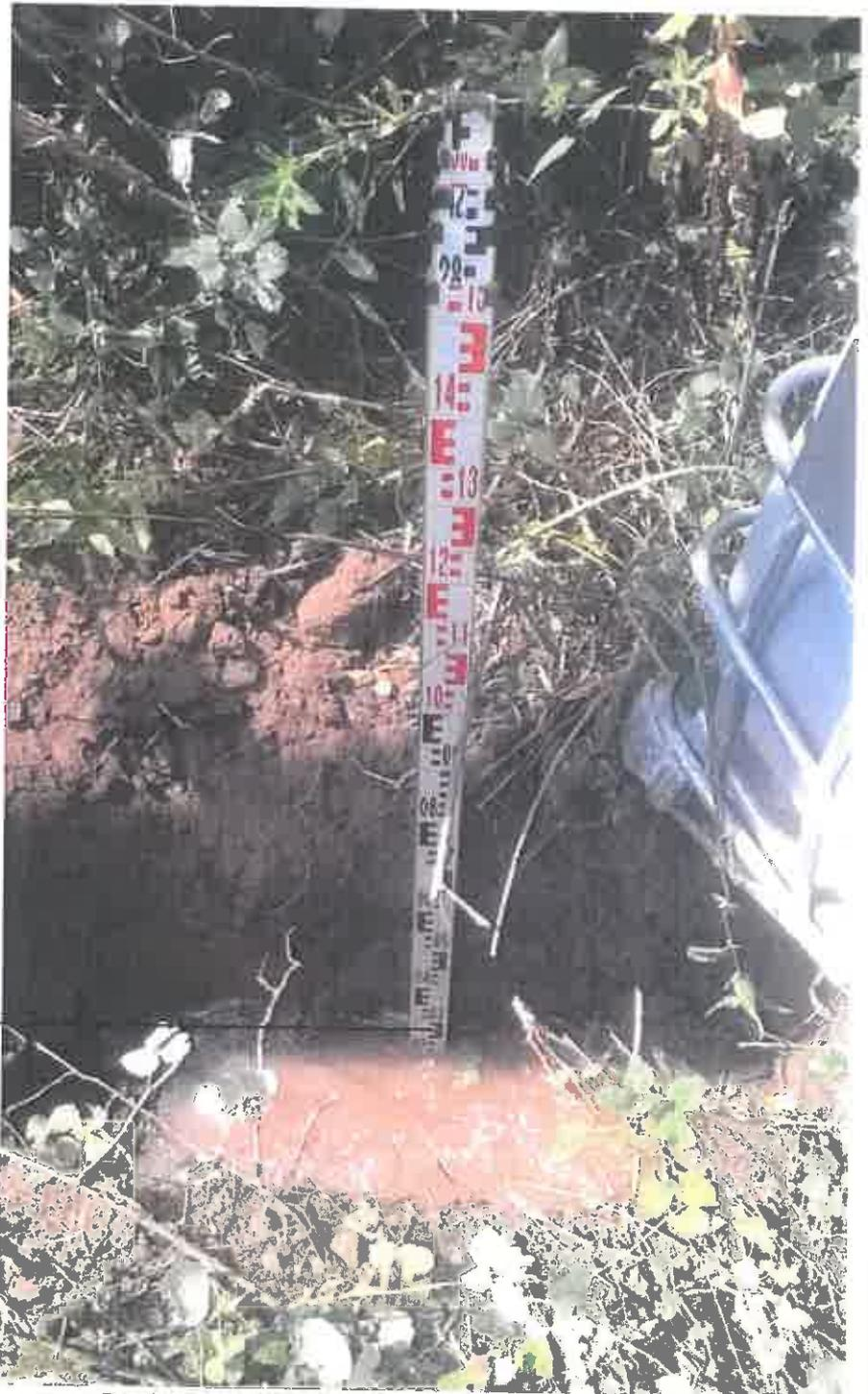
Essai de perméabilité "en grand" entre 0,67 m et 0,9 m de profondeur
