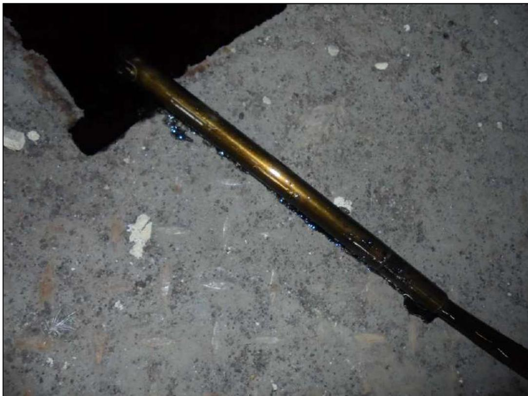
**Vue n°14 : vue sur les hydrocarbures contenus dans la fosse et déposés sur la sonde de mesure**
