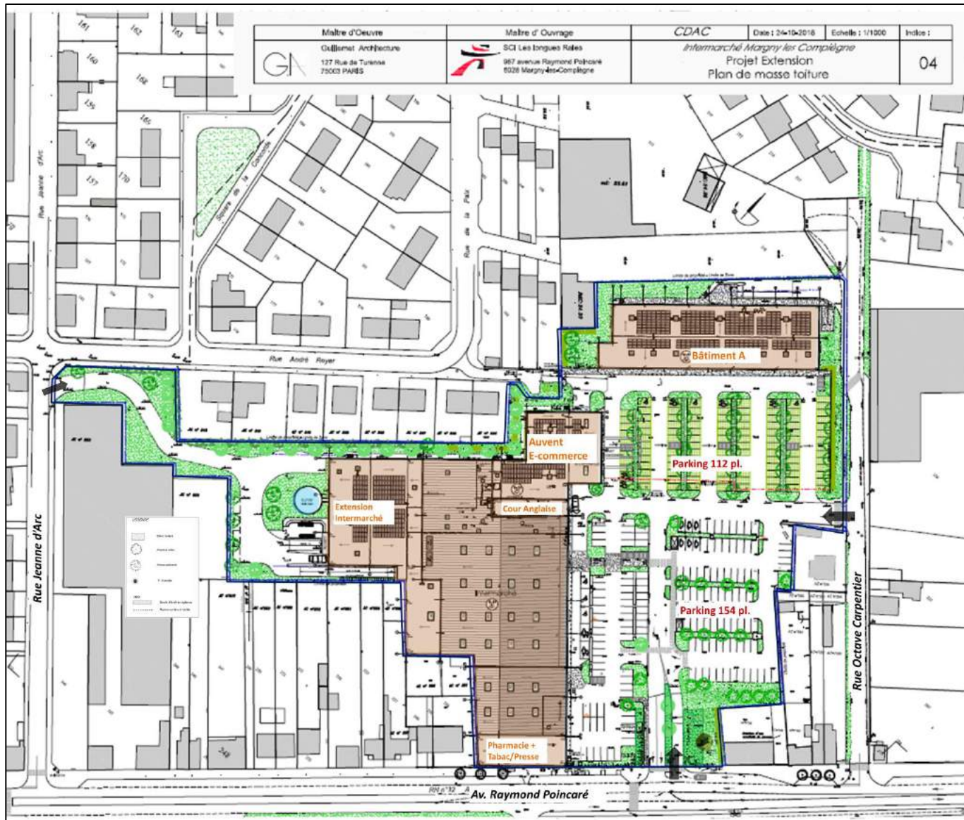
Fig. 18. Plan de masse du projet – localisation globale des accès, bâtiments et parkings (Source : Permis de construire)
