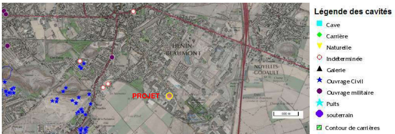
Figure N°14 : Carte de localisation des cavités souterraines
