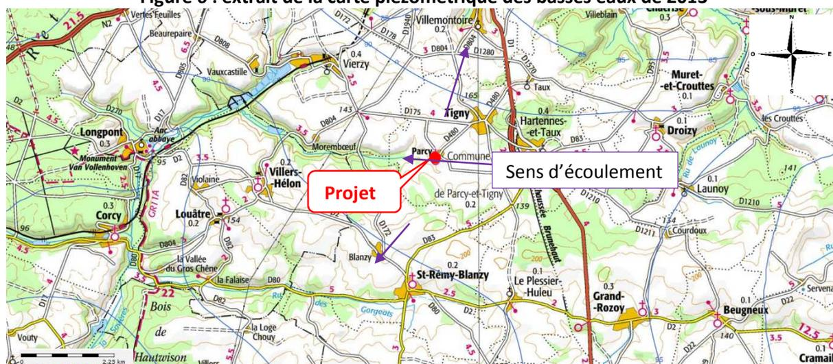
En 2013, le niveau d'eau au droit du site était d'environ + 91 m NGF avec un écoulement vers le nord.
