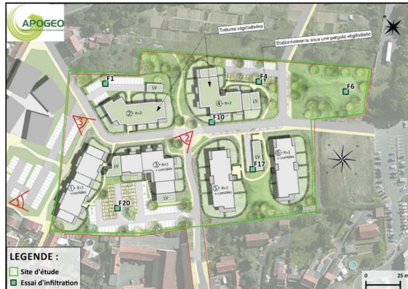
Figure 8 : Localisation des fouilles utilisées pour les essais d'infiltration
