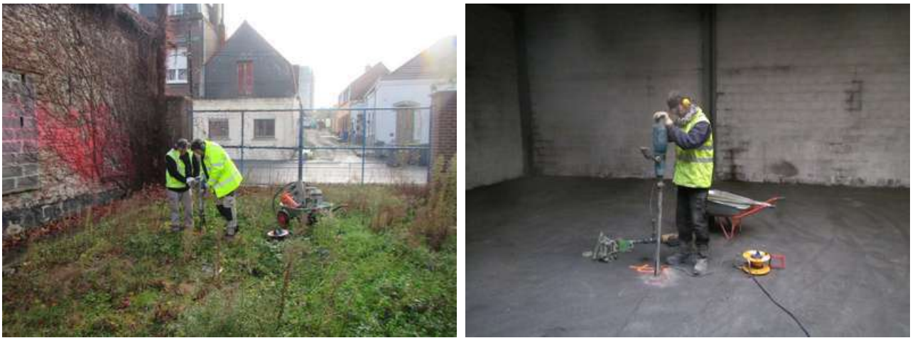
Figure 8 : Technique de forage au carottier portatif à gouges
