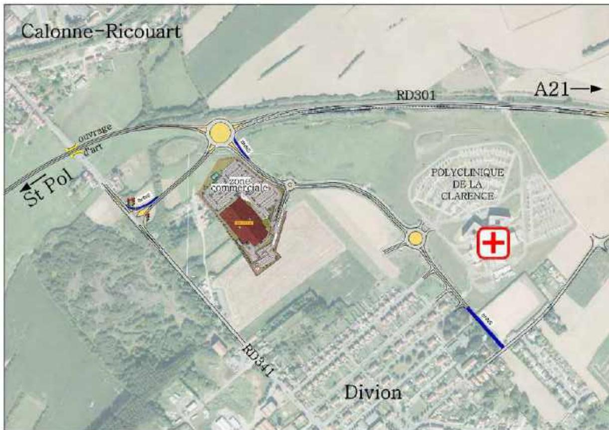
Section 1-Variante E: Création d'un ouvrage d'art et d'un carrefour T sur la RD 941.
