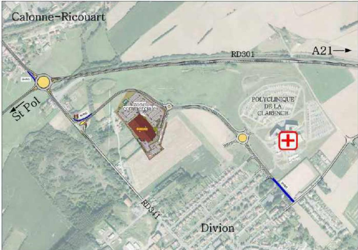
Section 1-Variante C : Création d'un giratoire 4 branches et d'un carrefour T sur la RD341
