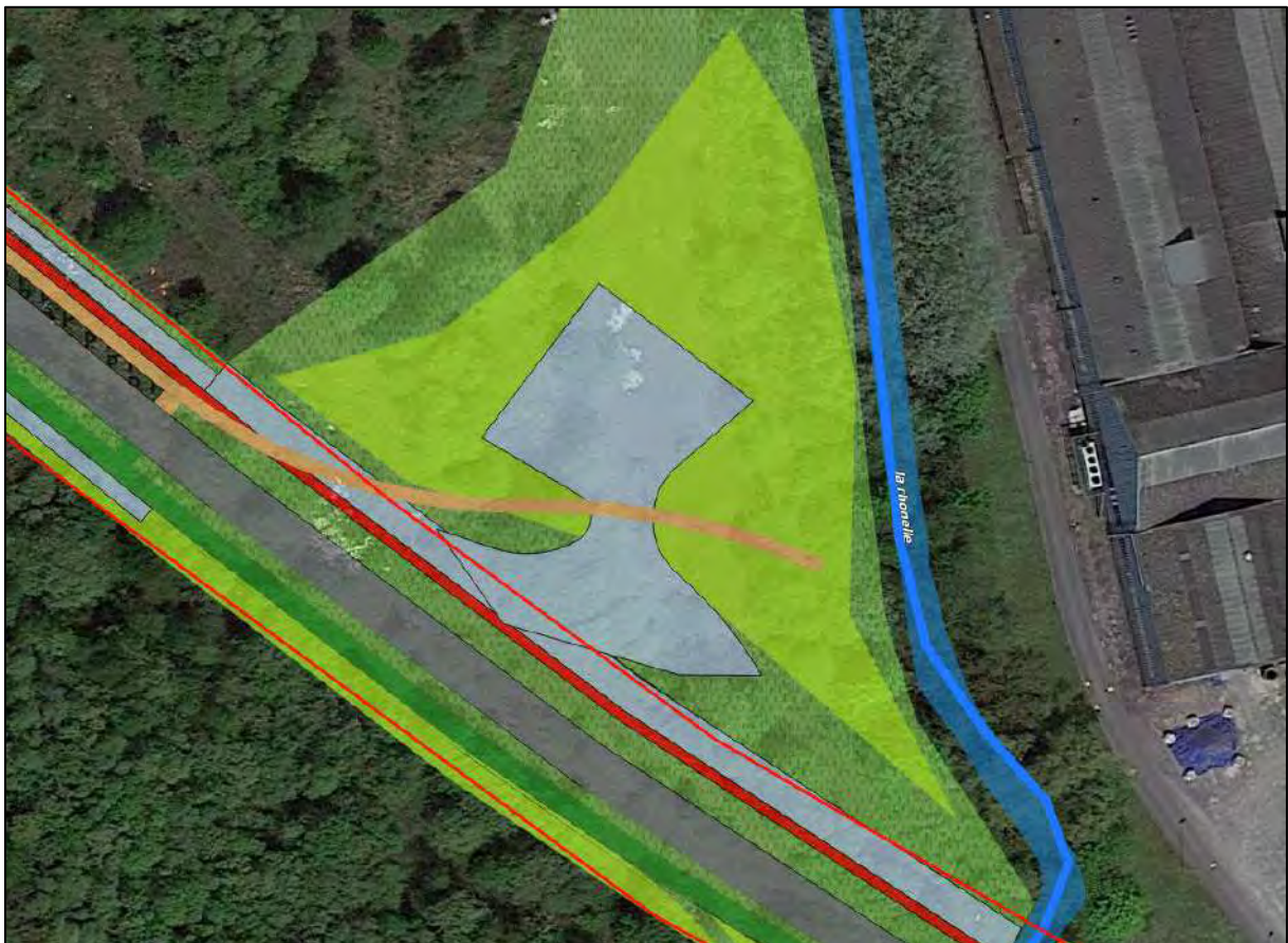
Bassin aménagé de gestion des eaux pluviales
