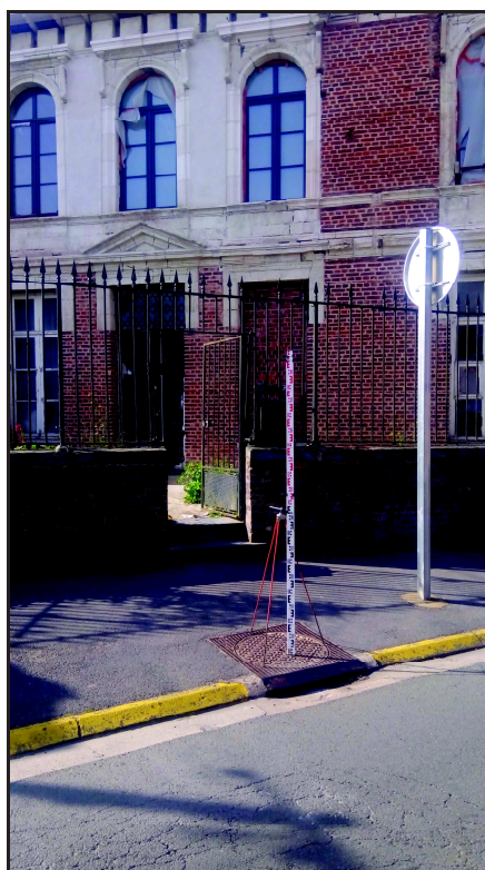
Fig. 3. Photographie de la référence de nivellement (regard situé rue Félicien Joly)
