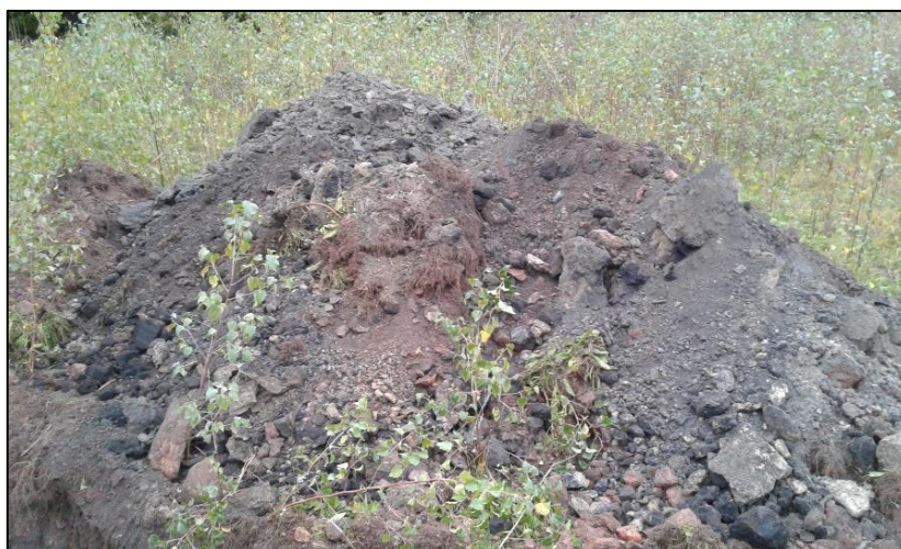
Vue n°2 : vue des déblais du sondage A1
