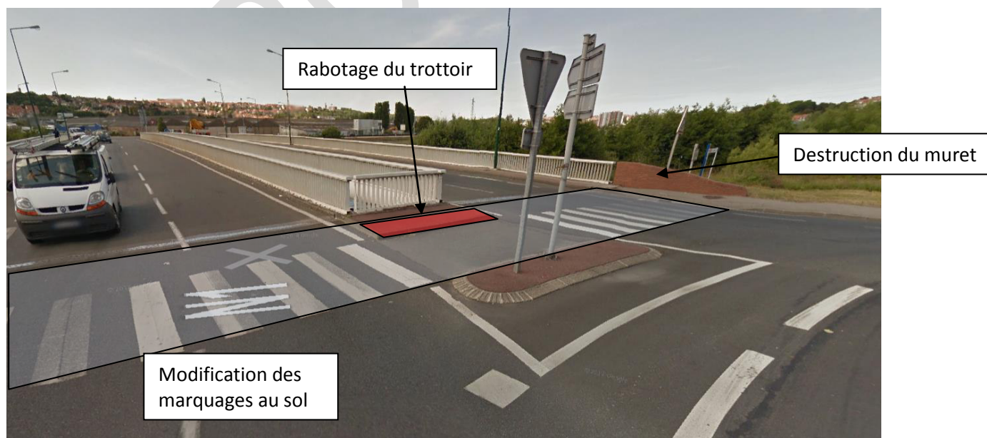
Figure 37 : Franchissement supérieur – principe de l'aménagement
