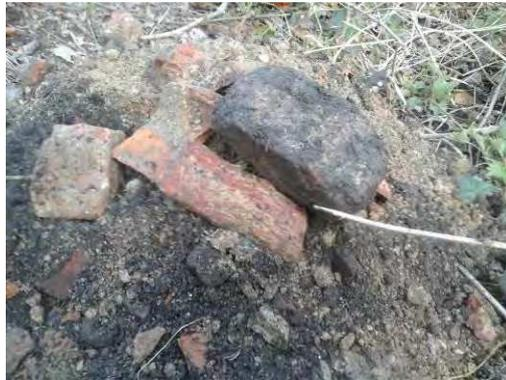
**Vue du type de déchets de démolition présents dans les remblais au droit des sondages S9 et S10**
