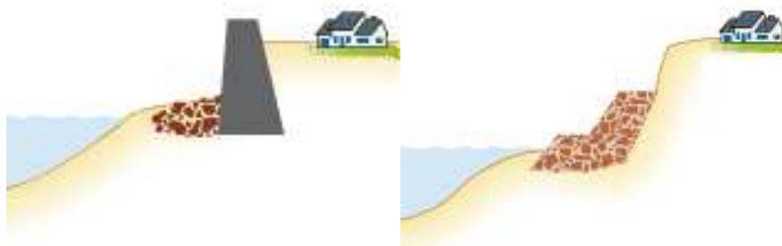
Figure 16 : Schéma d'illustration des ouvrages longitudinaux selon une vue en coupe (perré à gauche et enrochement à droite) (Source : La gestion du trait de côte, éditions Quae)
