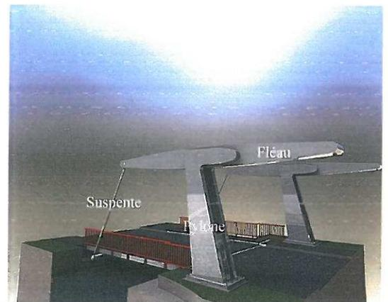
Pont mobile en position baissée
