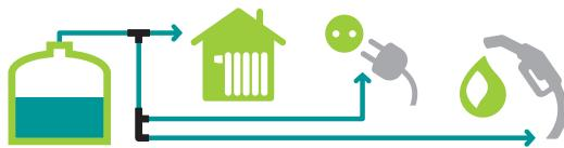
**Un méthaniseur** permet de valoriser les déchets d'exploitations en les mélangeant avec des déchets verts et organiques. Il peut couvrir les besoins de chaleur et d'énergie de l'exploitant et réduire ainsi ses charges. L'électricité produite est renvoyée dans le réseau public de distribution et rachetée à l'exploitant.
