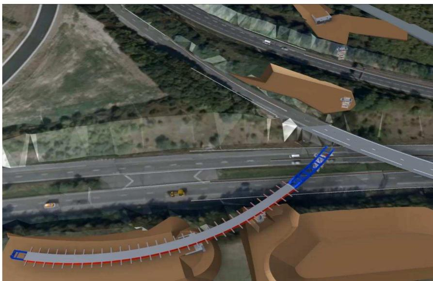
*Illustration du lancement de la charpente métallique du viaduc*
