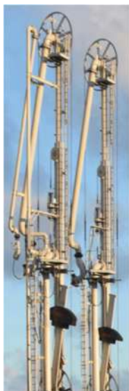
Figure 4 : bras de chargement/déchargement.
