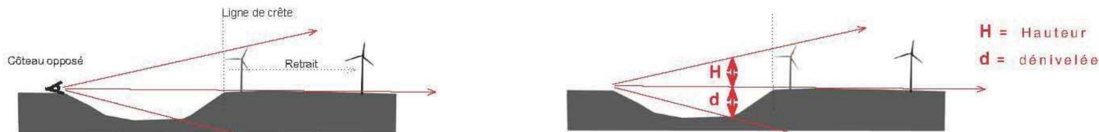
Le retrait des éoliennes par rapport à la ligne de crête détermine l'impact visuel autant que la hauteur des éoliennes utilisées.
