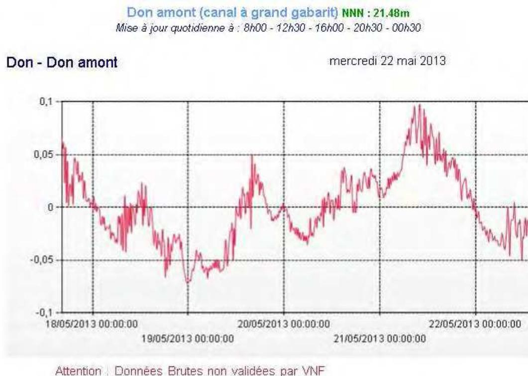
Figure 23 : Suivi de la différence de hauteur d'eau par rapport au NNN (en m) au niveau de la station de Don amont (export le 22 Mai 2013 du site <http://gestionhydraulique.free.fr>)
