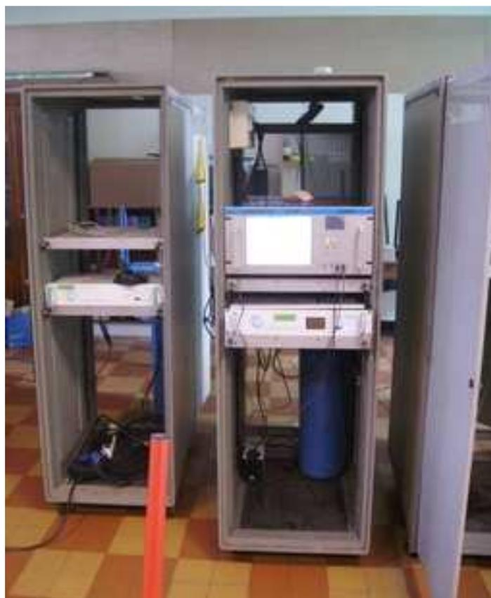
appareil de mesures en continu de la concentration en benzène
