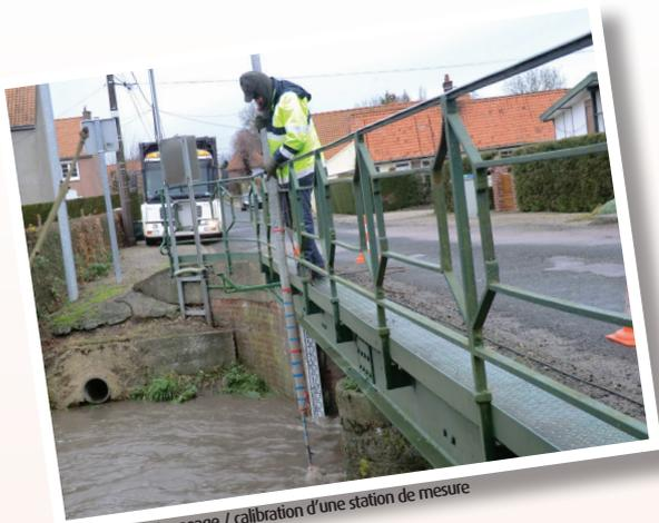
Opération de jaugeage / calibration d'une station de mesure
