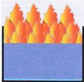
2. Les substances à haut point d'ébullition ne brûlent pas, forment une couche chaude qui s'enfonce doucement dans le réservoir.
