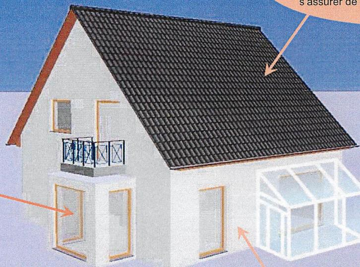
Les **parois opaques** constituées de béton ou d'éléments de béton, de terre cuite, de béton cellulaire, de pierre manufacturée ou naturelle, de pierre de taille et moellons équarris, de tous types de terres et de torchis (avec paille non apparente) **ne nécessitent pas de travaux d'amélioration**.
