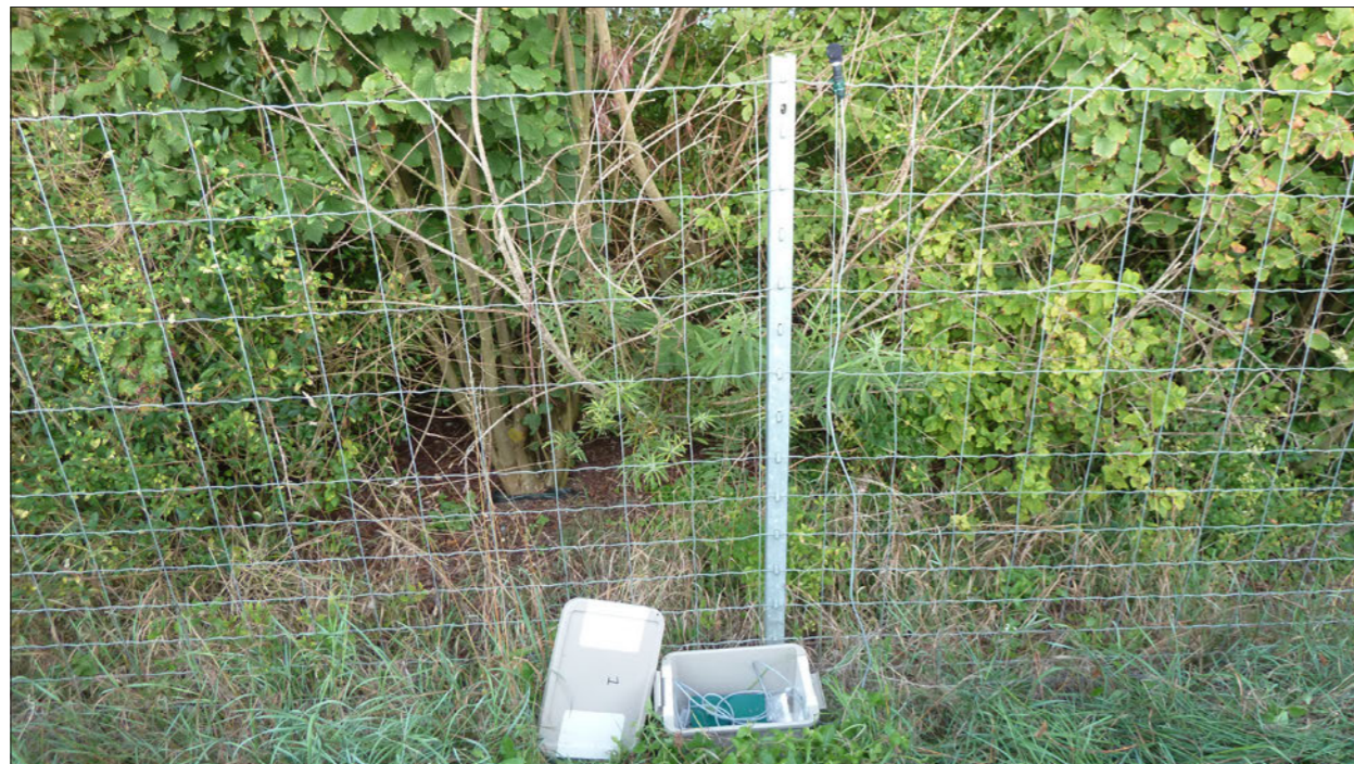
Photo 16 : Enregistreur automatique SM2BAT
