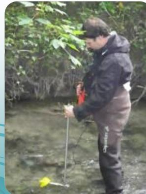
Mesure des vitesses d'écoulement avant
