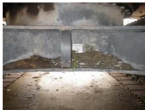
Transport de graines et de fragments de plantes avec les engins de chantiers
