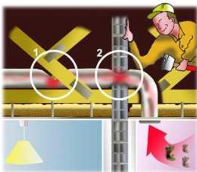
Écrasement des gaines entraînant des dysfonctionnements, bruit, débit insuffisant, déséquilibre de l'installation...etc
