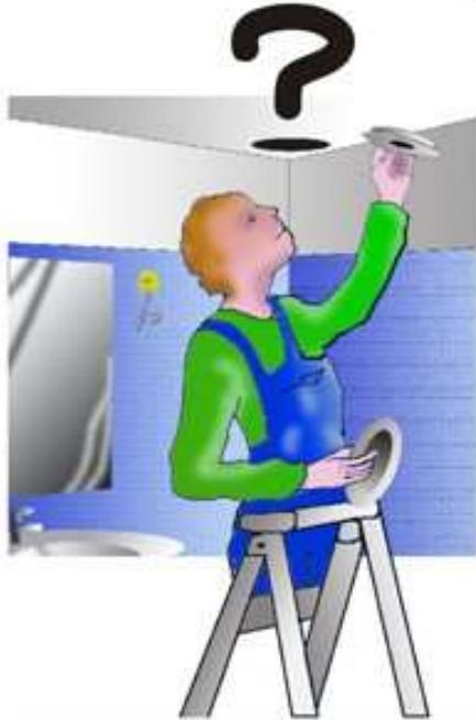
**Inversion des bouches d'extractions entraînant une mauvaise répartition des débits extraits dans le logement.**
