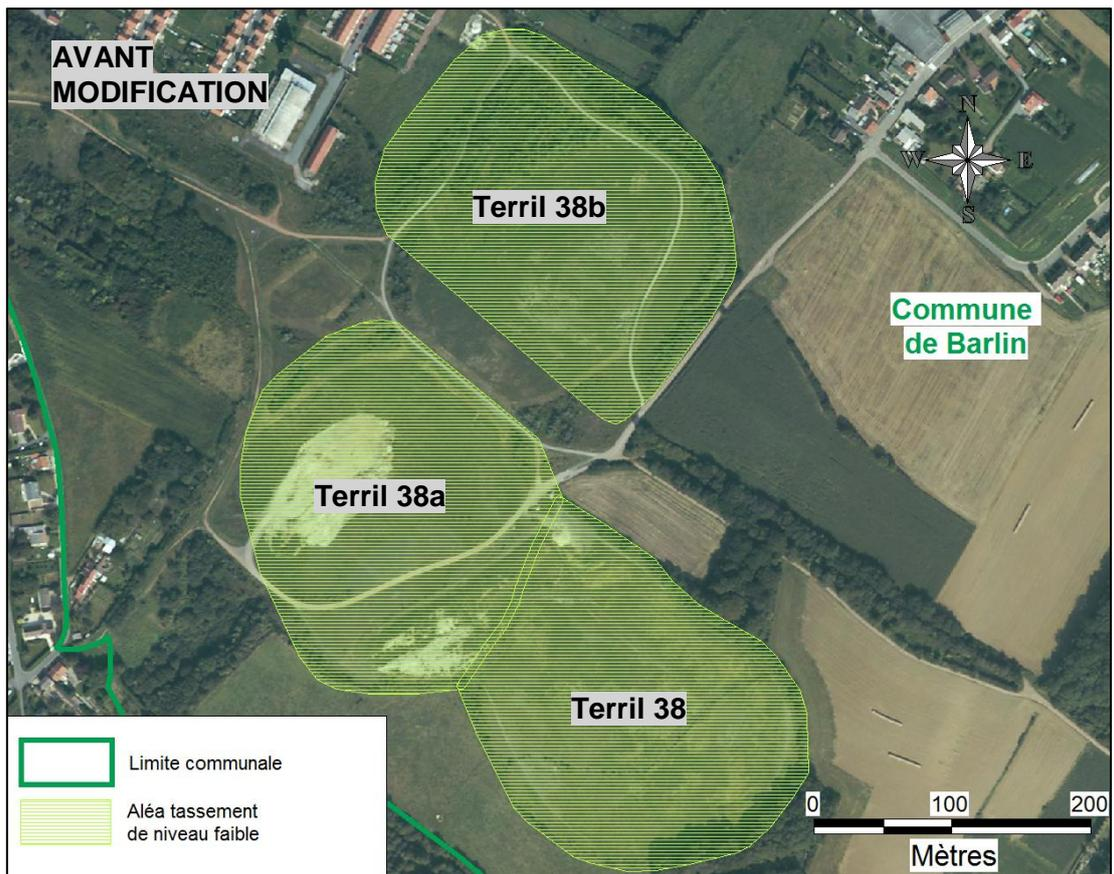
Figure 13 : Cartographie de l'aléa tassement avant modification (fond Orthophoto 2004)
