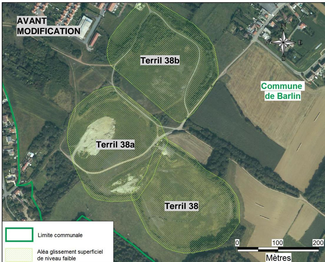
Figure 11 : Cartographie de l'aléa glissement superficiel avant modification (fond Orthophoto 2004<sup>1</sup>)
