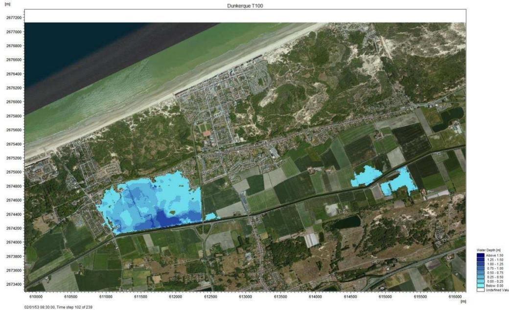
Propagation canal du Furnes à  $T_0$
