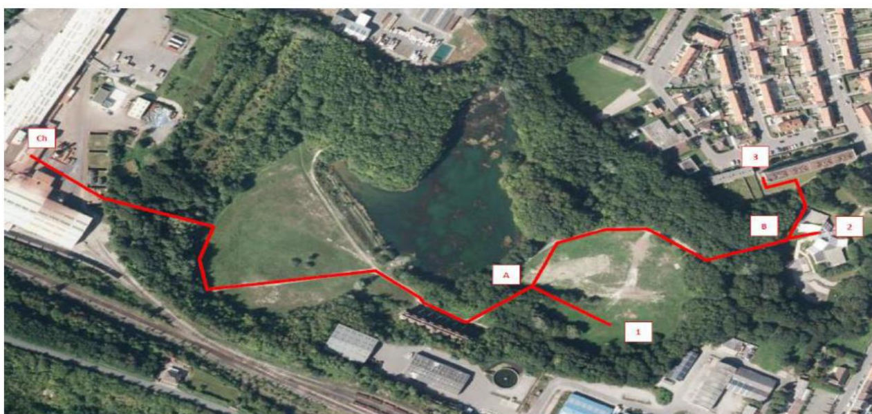
Figure 9. Schéma prévisionnel du réseau de chaleur qui desservira les installations locales (Source : Communauté de communes de Desvres-Samer)
