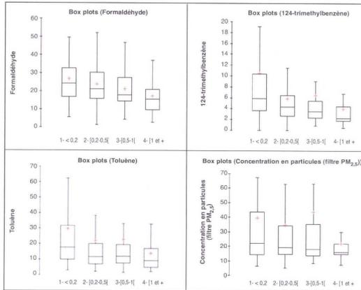
Figure 6. Concentrations intérieures (en µg/m<sup>3</sup>) selon les niveaux de renouvellement d'air des logements.
