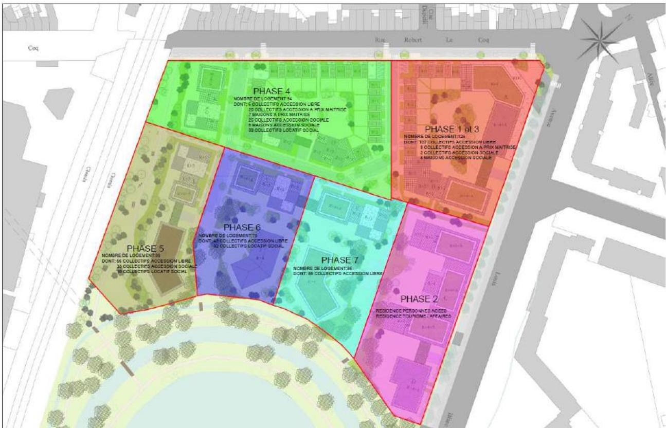
**Figure 4 : Phasage de l'opération, sans échelle**
