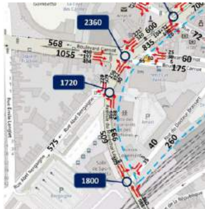
Trafic en HPM sur la zone d'étude (Source : étude Egis 2019)
