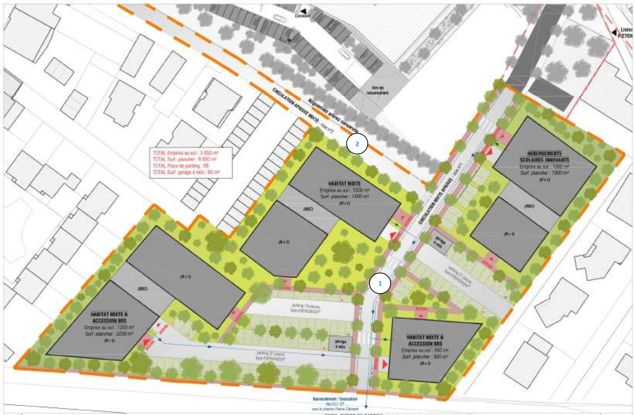
Plan du projet global réalisé au terme de l'expropriation à l'échelle 1/500 ème faisant apparaître les deux voiries à réaliser : voie 1 et voie 2
