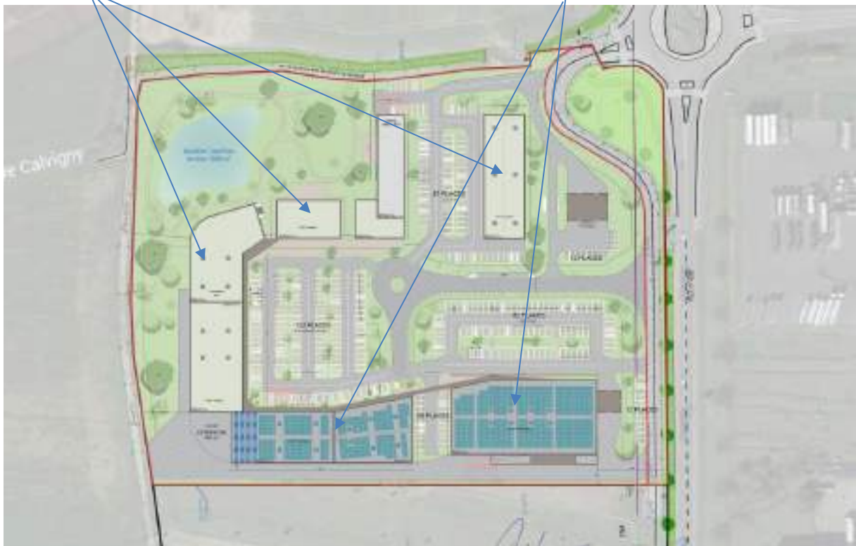
Plan des toitures végétalisées et photovoltaïques
