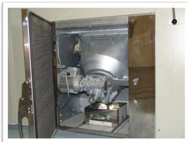
Particulièrement adapté aux faibles volumes, le dispositif de pulvérisation est positionné sous le dispositif d'introduction du FT III (SE). Au cours de la pulvérisation, les calcius migrent de la cuve technique au réceptacle de collecte. A l'issue de la pulvérisation, l'opérateur effectuera le transfert du réceptacle de collecte à l'urne familiale prévue à cet effet.
