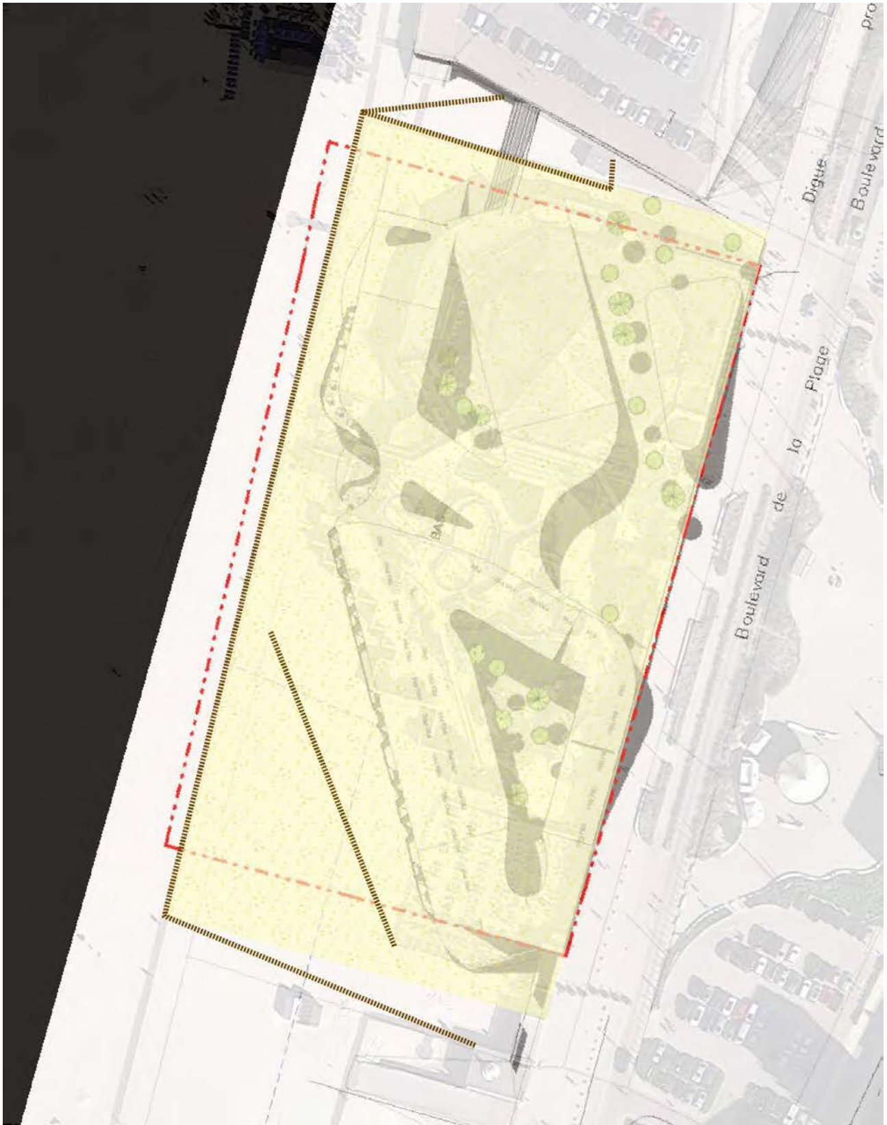
Carte 11 : Exemple de pose de ganivelles possible pour limiter les envois de sable en phase travaux
